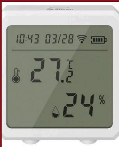
Este instrumento manual mide la humedad actual, así como la temperatura actual de aire sobre un sensor fijo para una evaluación rápida y precisa de los resultados de medición. La pantalla LCD de fácil lectura está equipada con una luz de fondo automática, que se activa en zonas de baja luminosidad mediante un fotodiodo. Además de la función de medición precisa, este dispositivo también ofrece una función de retención de datos.
